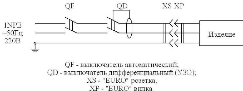
Рис. 2. Схема подключения изделия к электросети.
